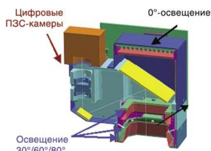
Рис. 3. Цифровая система технического зрения
